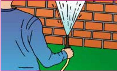
02 Verschmutzungen vermindern eine gute Aufnahme des Produkts, verschmutzte Oberflächen sind also zuvor auf geeignete Weise zu reinigen.
